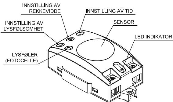
ECOMAT MINI 2N er en tilstedeværlessensor som fanger opp selv minste bevegelser ved hjelp av den innebygd høyfrekvensteknologien. Sensoren følsomhet blir ikke påvirket av omgivelsestemperaturen. Den detekterer umiddelbart alle bevegelser (også bevegelige komponenter, slik som dører, stoler, etc.).
