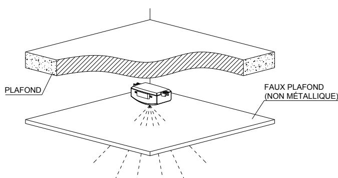
Le capteur doit être orienté vers la zone dans laquelle nous voulons que se produise la détection.
