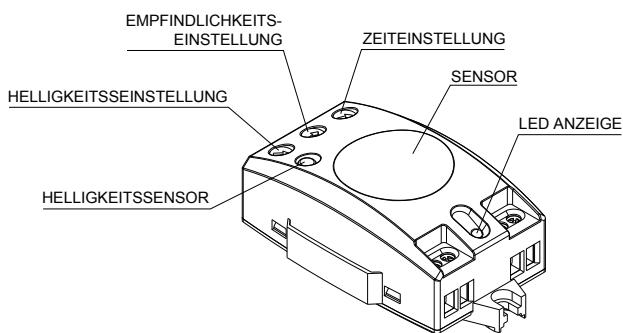
Der Präsenzmelder ECOMAT MINI 2N kann die geringste Bewegung erfassen dank seiner Hochfrequenztechnologie. Seine Erfassungsgenauigkeit hängt nicht von der Umgebungstemperatur ab. Das Gerät erfasst sofort jede Art von Bewegung, sogar unbewegliche Elemente wie z.B. Türen oder Stühle. ECOMAT MINI 2N verfügt über eine Reichweite von bis zu 10 m mit einem Erfassungsbereich von 360°.
