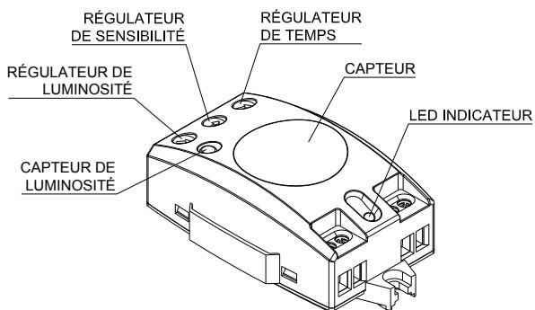
Le détecteur de présence ECOMAT MINI 2N est capable de détecter le moindre mouvement grâce à sa technologie de haute fréquence. Sa précision de détection ne dépend pas de la température ambiante. Il détecte immédiatement tout mouvement, et même des éléments inertes comme des portes ou des chaises, par exemple.
