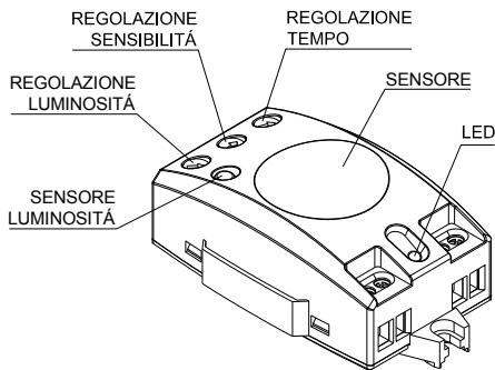
Il rivelatore di presenza ECOMAT MINI 2N è in grado di individuare il minimo spostamento grazie alla tecnologia ad alta frequenza. La precisione di rilevamento non dipende dalla temperatura ambiente. Rileva in modo immediato qualsiasi movimento, inclusi gli elementi inerti, come per esempio: porte o sedie.
