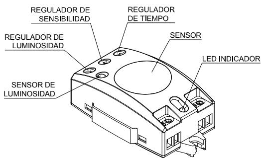
El detector de presencia ECOMAT MINI 2N es capaz de detectar el más mínimo movimiento gracias a su tecnología de alta frecuencia. Su precisión de detección no depende de la temperatura ambiente. Detecta de forma inmediata cualquier movimiento, incluso elementos inertes como por ejemplo: puertas o sillas.
