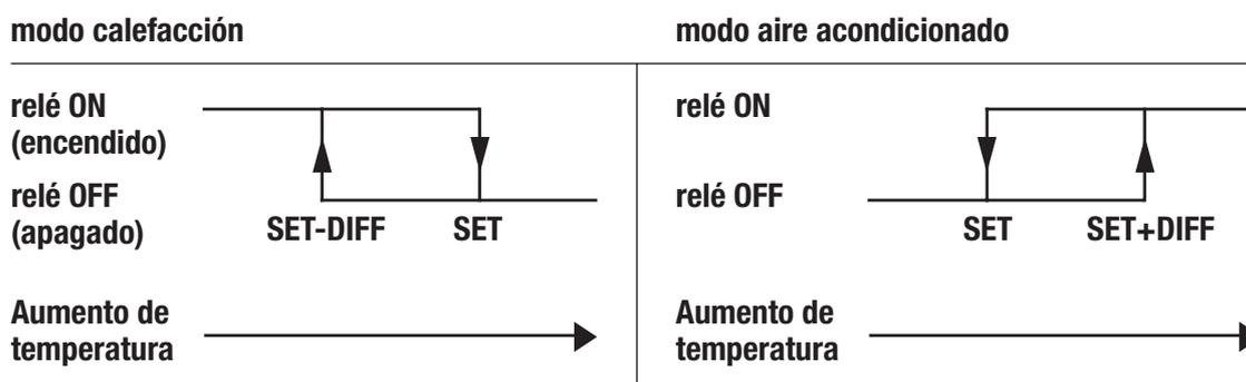
donde SET (ajuste) representa el punto de ajuste y DIFF (diferencia) la histéresis (útil para evitar continuos encendidos/apagados peligrosos para el sistema cuando está próximo a alcanzar el punto de ajuste).
