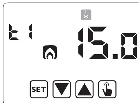
3. Se muestra el valor de la temperatura T1 en forma parpadeante. Modificar el valor con las teclas ▲ y ▼ y pulsar la tecla
