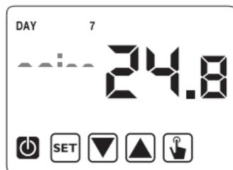
**Das programmierbare Thermostat bewahrt den Zustand für OFF-Betrieb, bis die Uhrzeit eingegeben wird und auf diese Weise ist die Beibehaltung der Antifrosttemperatur (6°C) gewährleistet.**
