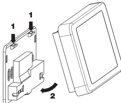
Atención: no es posible realizar la programación o modificación de los parámetros ajustados hasta que el aparato no esté correctamente instalado en la base montada en pared.
