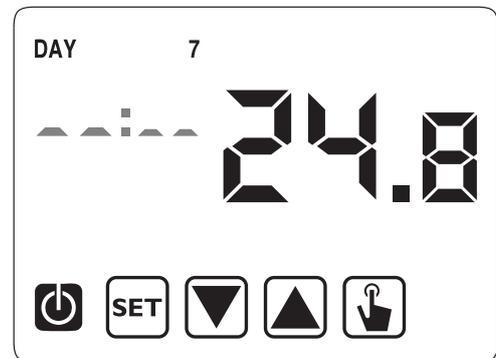
**El termostato programable permanece en condiciones de funcionamiento apagado hasta que no se inserte la hora, asegurando de esta forma el mantenimiento de la temperatura antihielo (6°C).**
