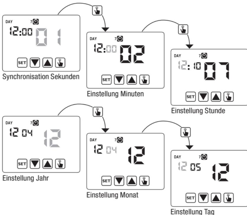
Wenn alle Werte eingestellt sind, 3 Sekunden lang Taste **SET** drücken, um das Menü für die Synchronisierung der Uhr zu verlassen.
