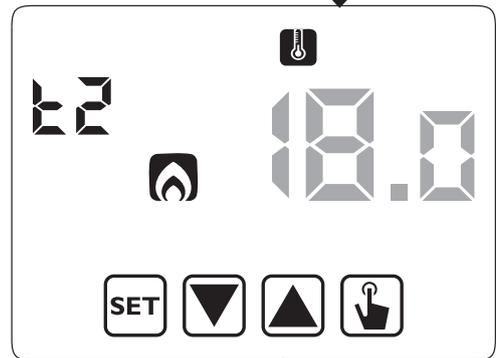
5. Se muestra el valor de la temperatura T3 en forma parpadeante. Modificar el valor con las teclas ▲ y ▼ y pulsar la tecla
